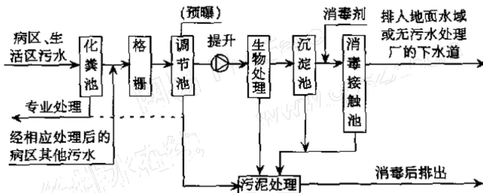
图 4.0.4-3 二级处理工艺流程
