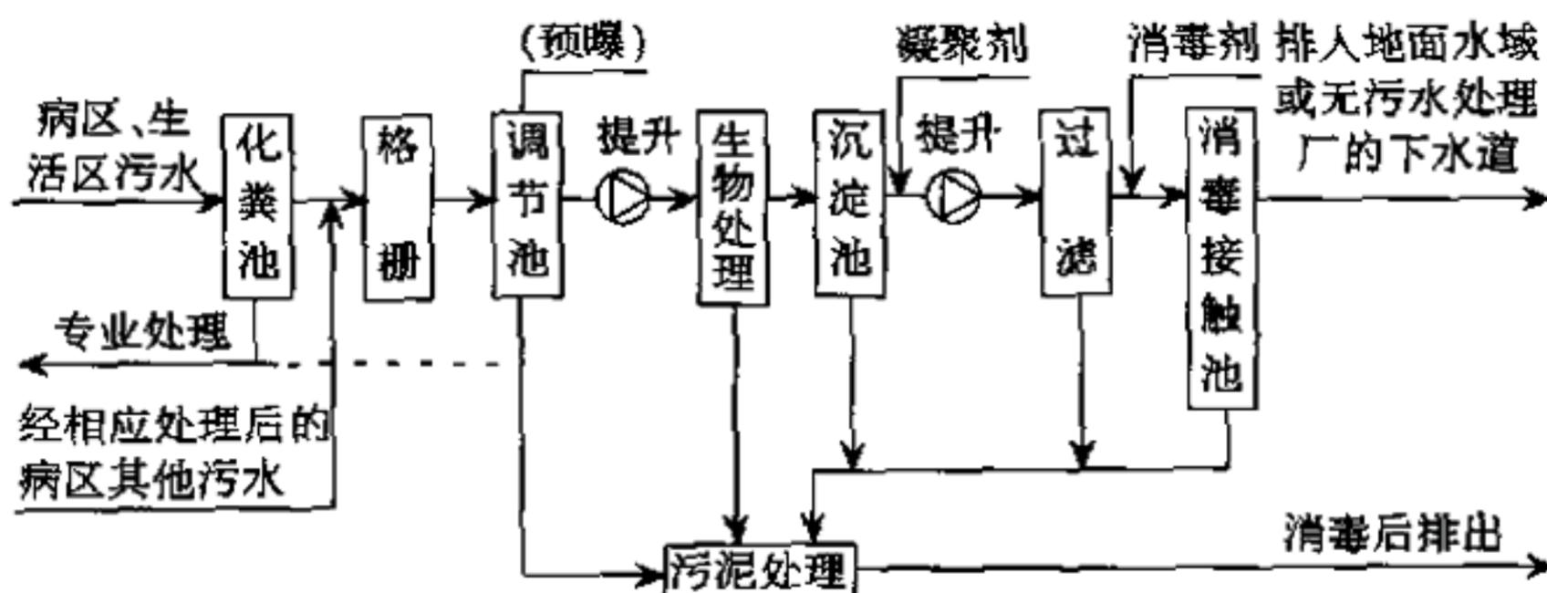
图 4.0.4-4 深度处理工艺流程
