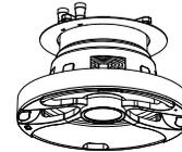
5. 扬声器组件接好音频线以后顺时针方向旋入固定支架。
