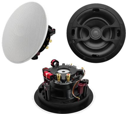
LB-611S是一款高音质吸顶扬声器。表面采用美观的黑色涂层和白色网罩，时尚精巧的外型可与现代化的室内装潢完美融合，相得益彰。低音采用聚丙烯振膜加橡胶折环，以表现平滑出色的低频响应和甜润温暖的中频；高音采用天然蚕丝球顶音膜，磁液冷却，钕铁硼磁钢，让声音清晰明亮，委婉动听；高音可因场地环境倾斜30度，360度内自由转动，并PTC过载保护；-12dB/Oct低通滤波器，-18dB/Oct高通滤波器，让每个扬声器工作在较佳的频带内。简单方便的功率设置，操作容易。适合于多种场合，特别在商店、百货公司、学校、办公室、酒店和餐馆内的内嵌式音响应用场合，可以发挥卓越的语音及音乐播放功能。
