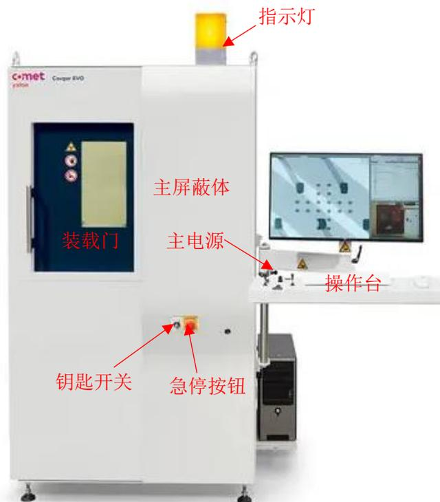
图 9-5 X 射线检测系统结构外观图
