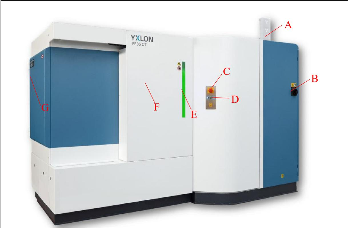
图 9-2 工业 CT 结构外观图
