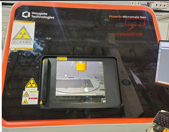
图 3-4.3 射线装置顶部设置的工作状态指示灯
