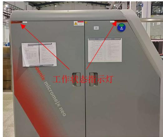
图 3-4.4 射线装置左侧设置的工作状态指示灯
