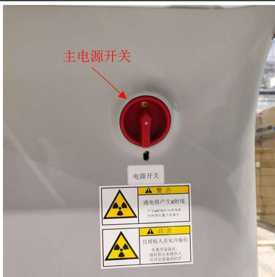
图 3-4.7 射线装置设置的主电源开关
