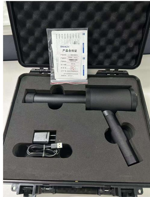
图 3-4.10 便携式 X-γ 剂量率仪
