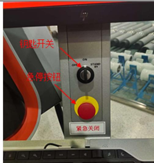
图 3-4.6 射线装置设置的急停按钮和钥匙开关
