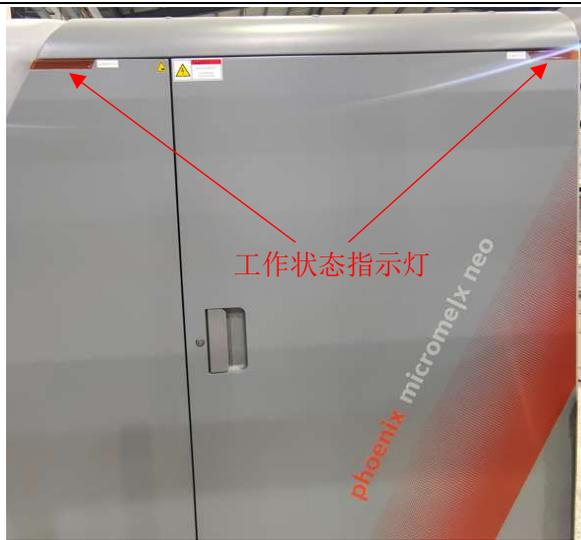
图 3-4.5 射线装置右侧设置的工作状态指示灯
