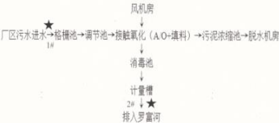
图三-1 南丹县罗富镇污水处理厂废水处理流程及监测点位图
