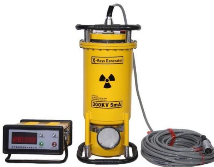
图 2-5 X 射线探伤机外观图
