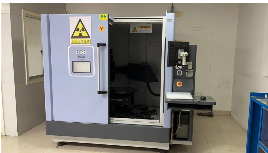
图 9-3 本项目 X 射线实时成像检测装置示意图
