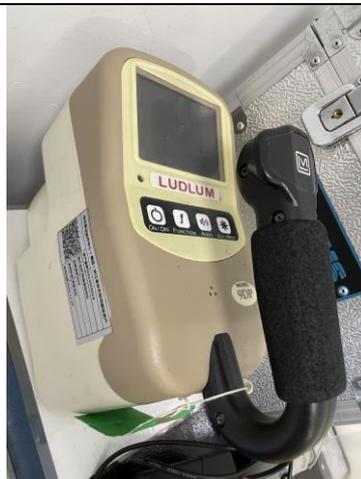
图 4-10 辐射剂量监测仪
