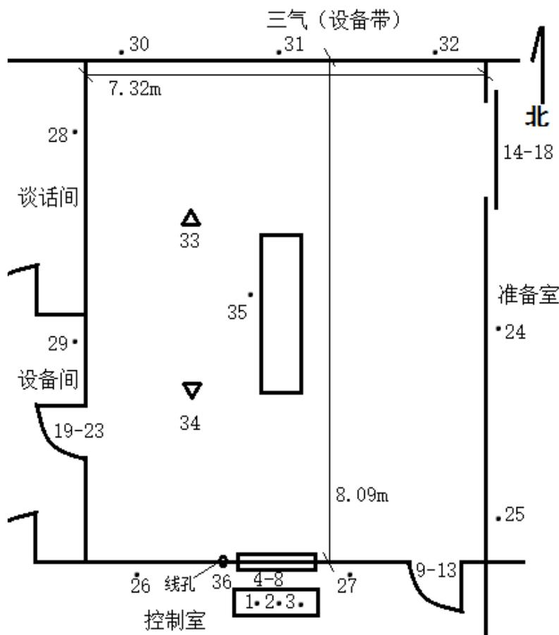
图 6-5 2#医疗综合楼南区一层急诊中心 DSA 机房监测布点示意图
