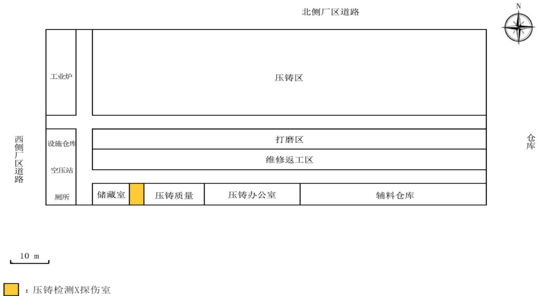
图 2-3 压铸车间平面示意图
