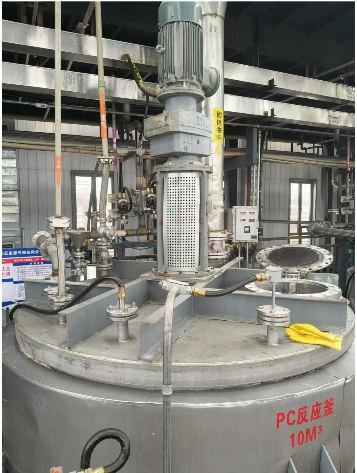
图 4.1-10 合成 PC 产品反应釜尾气收集装置
