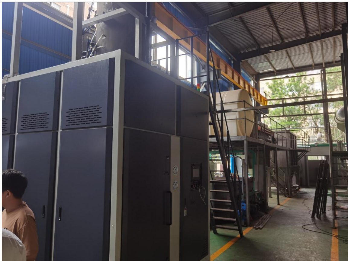
酸洗废水处理设施（处理后循环回用）
