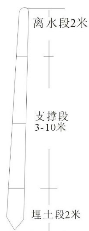
图1 插杆结构示意图
